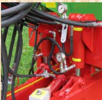
Гидравлическая колодка и гидравлическая амортизация дышла
