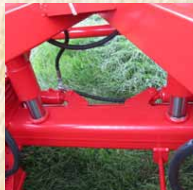
Серийная гидравлическая подвеска заднего моста на всех моделях.
