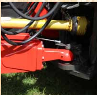
Принудительное управление с помощью троса Боудена.
