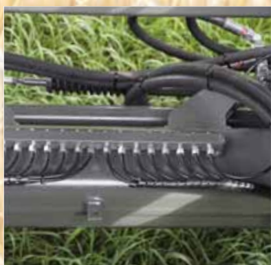
Линии смазки на мостах. Централизованное расположение точек смазки.
