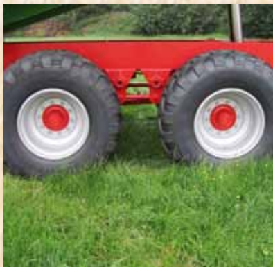
Массивная серийная ходовая часть с мостами BPW на параболических рессорах и с крупными тормозными блоками.
