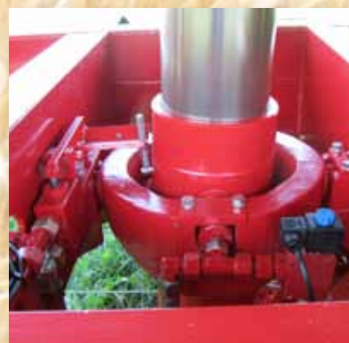
Клапан отключения и быстрого опускания на опрокидывающем цилиндре.
