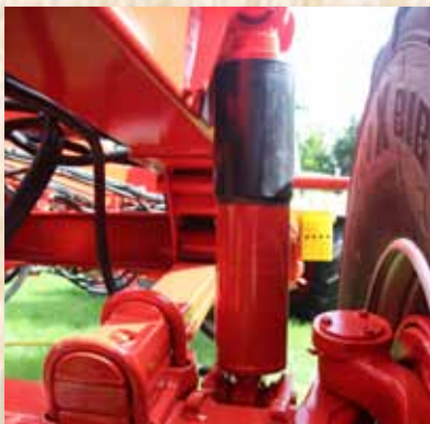
Шасси с гидравлической подвеской.
