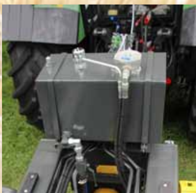
Снабжение маслом через бортовую гидравлическую систему с электрогидравлическим блоком управления.
