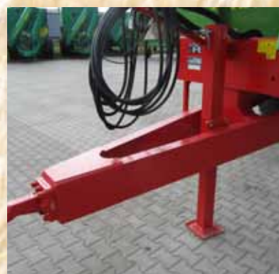
Гидравлическая стойка и механическая амортизация дышла.
