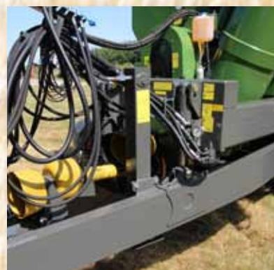
Гидравлическая стойка и гидравлическая амортизация дышла.
