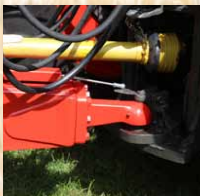
Принудительное управление с помощью троса Боудена.
