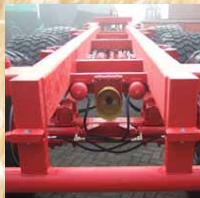
Тридемпное шасси с серийным сквозным приводом вала отбора мощности для приводов кузовов.
