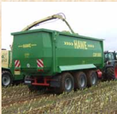
Грузовой кузов с выдвижным бортом объемом 40 или 50 кубометров.
