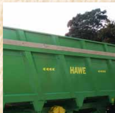
Бортовая надстройка (300 мм) для компоста и других легких материалов.
