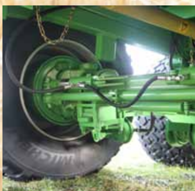
Инерционная управляемая ось с гидравлической системой блокировки; автоматическое выравнивание хода позволяет достичь прямолинейного движения по инерции.
