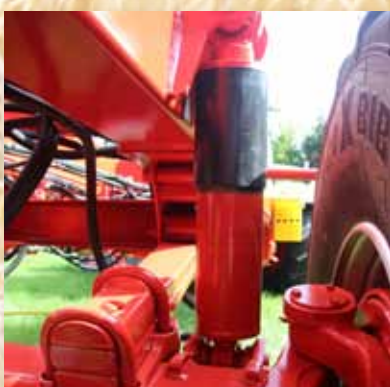
Шасси с гидравлической подвеской, включая поддерживающую ось.
