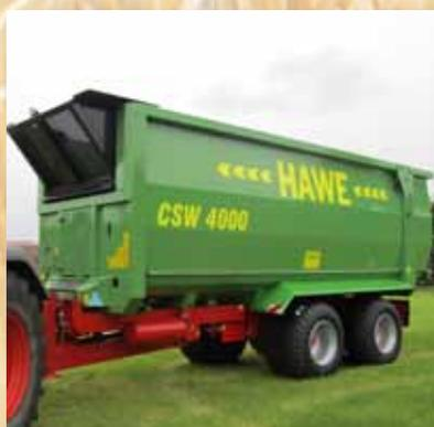
HAWE CSW 4000 с гидравлически поддрессоренным тандемным шасси с подъемной и поворотной осями. Оснащенной гидравлической
