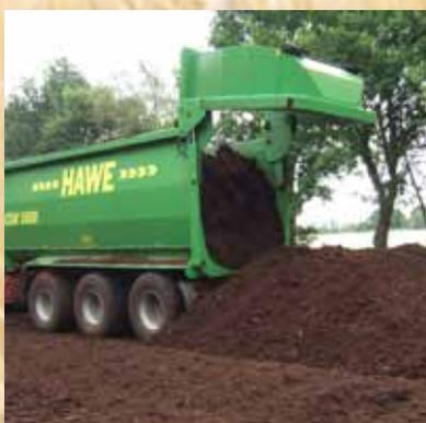
подвеской, с дополнительным подъемным мостом и поддерживающим управляемым мостом. HAWE CSW 5000 с параболическим тридеммным шасси, 1-й и 3-й автоматически поворачиваемыми осями. Опционально - принудительное управление.
