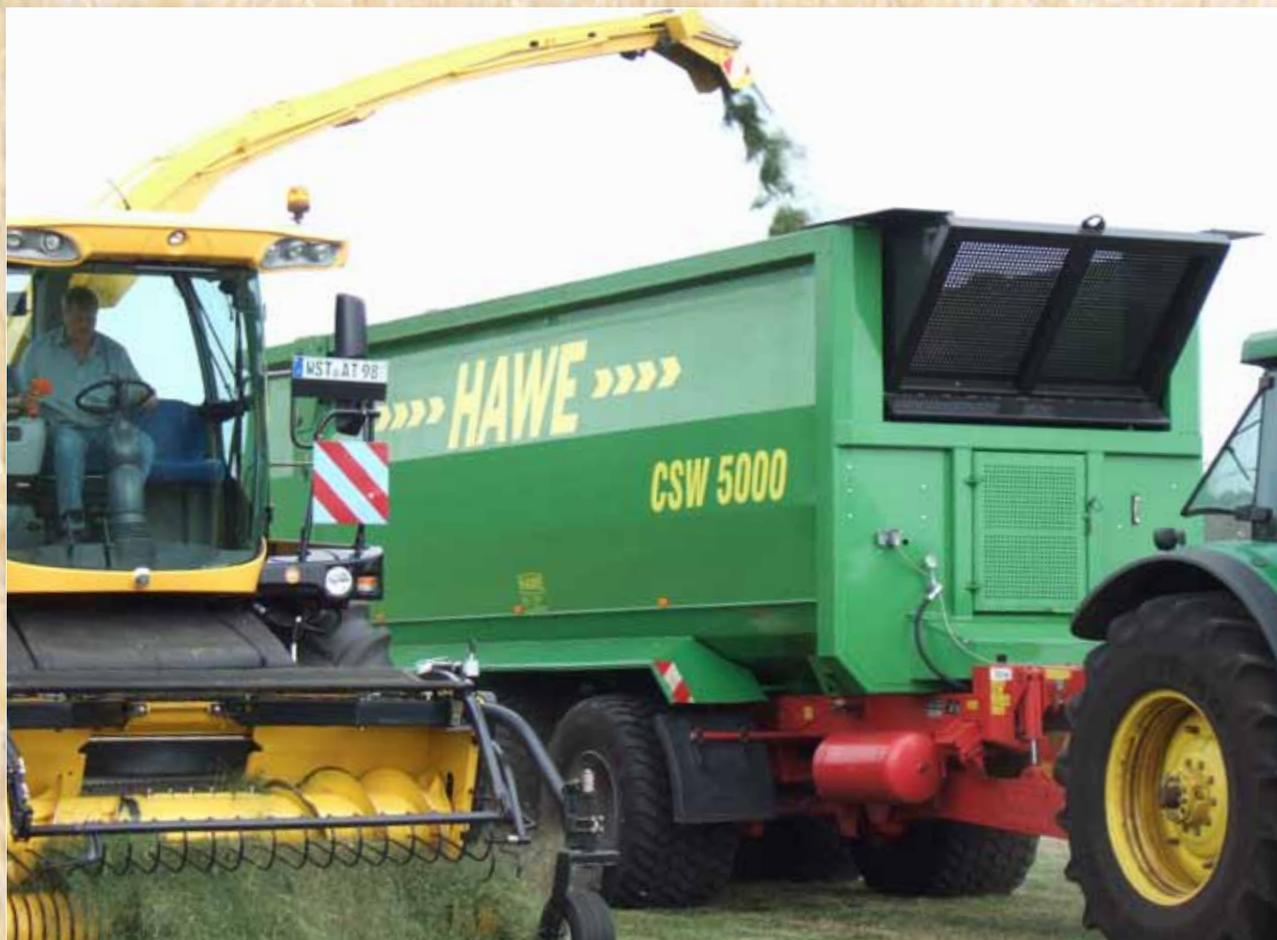
Корпусная конструкция прицепов HAWE с выдвигаемым бортом отличается устойчивостью к высоким нагрузкам. Движущийся
